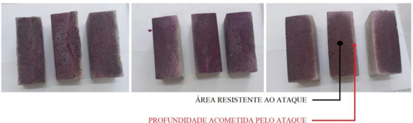
**Figura 6** – Efeitos do ataque por sulfatos sobre o concreto (DE LIMA e SILVA *et al.*, 2018).
